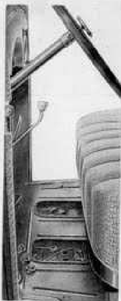
Vue montrant la facilité d'accès aux accumulateurs. On aperçoit sur le plancher les 3 bouchons démontés pour vérifier le niveau de l'électrolyte.
